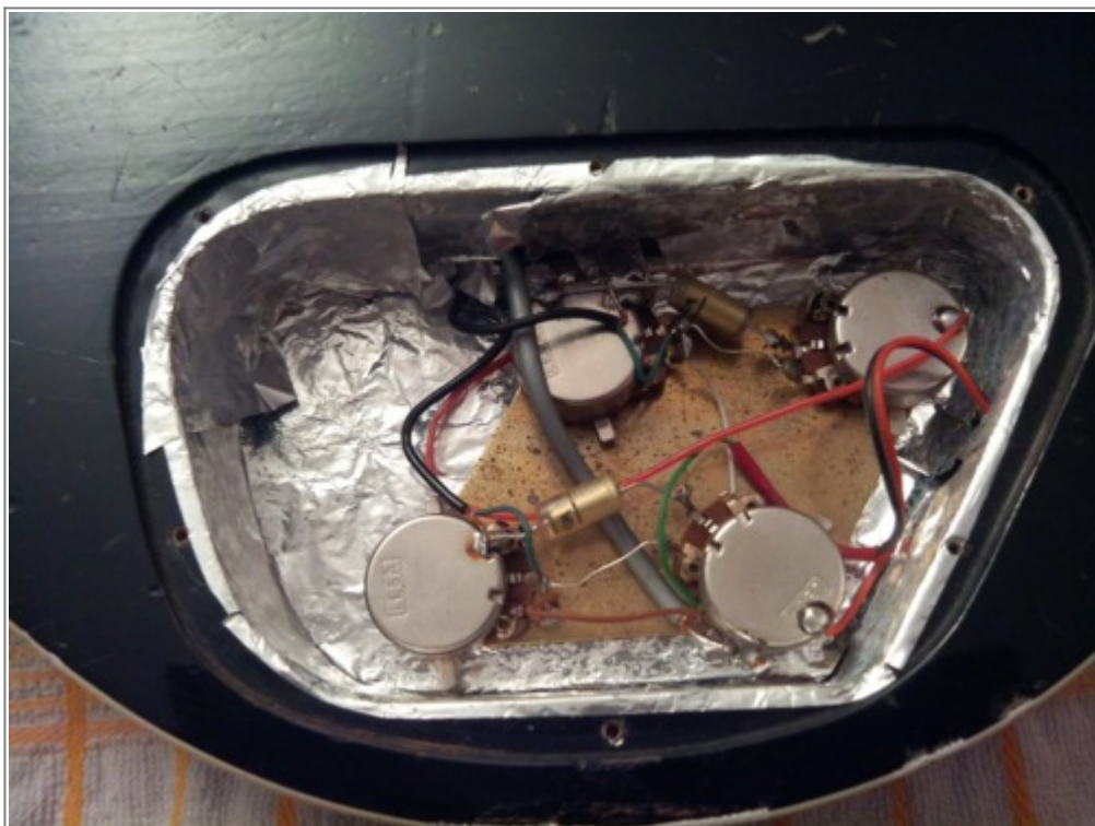
Les condensateurs originaux encore en place.
