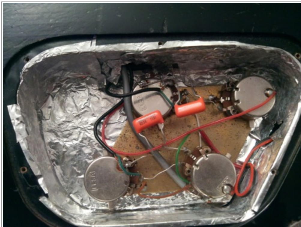
Les nouveaux condensateurs installés.
