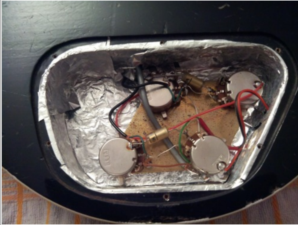
Les condensateurs originaux encore en place.
