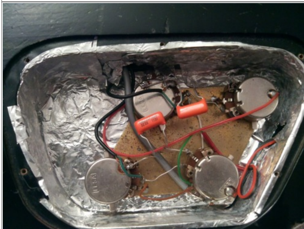
Les nouveaux condensateurs installés.
