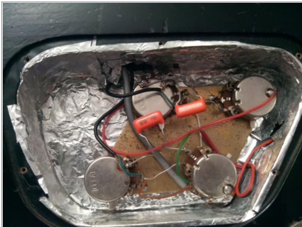
Les nouveaux condensateurs installés.
