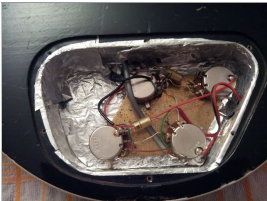
Les condensateurs originaux encore en place.
