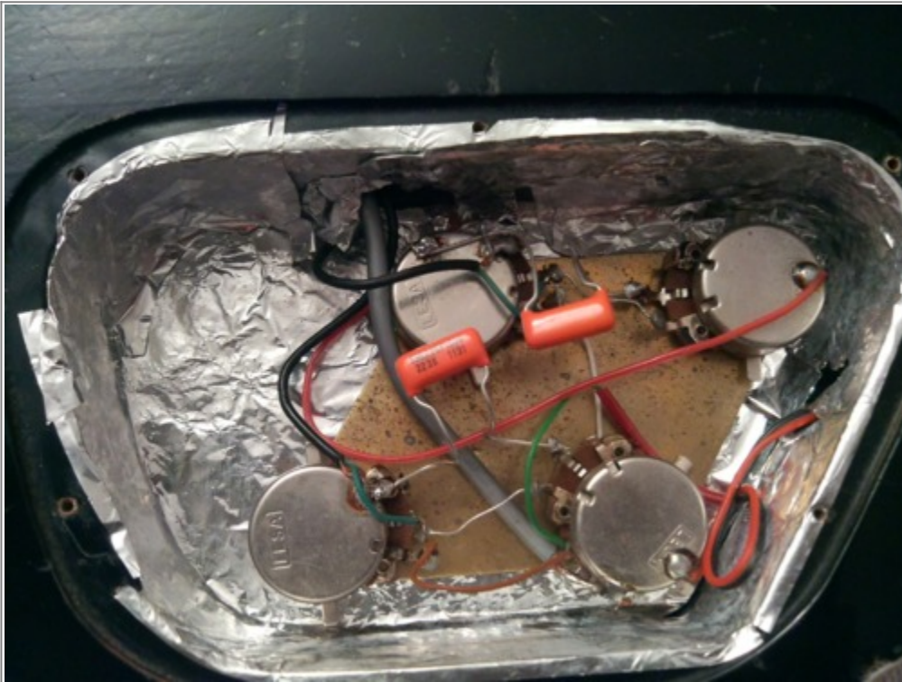
Les nouveaux condensateurs installés.
